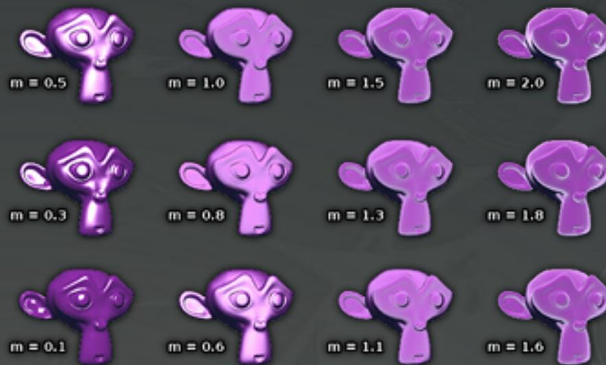
На практике распределение Бекмана часто используют в более сложных моделях (например, в модели Кука-Торренса). Модели с учетом микрограней позволяют наиболее реалистично передавать фактуру различных тканей (бархата, вельвета, шелка) и органических поверхностей.
