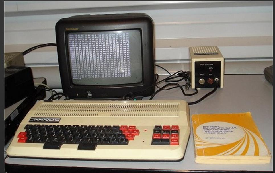
«Львов», в основном, использовался как учебная машина в школах и вузах. Были разработаны новые модели компьютера – ПК-02 с увеличенным объемом памяти и ПК-03 на базе i8088, который работал под управлением MS DOS, однако они так и не вышли в массовое производство в связи с распадом СССР.
