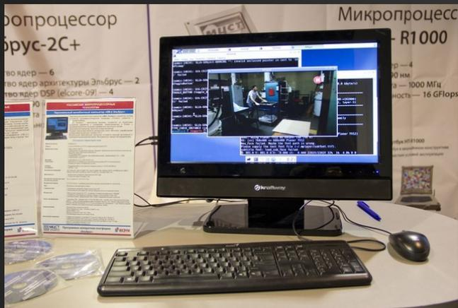
На основе Эльбрус-2С+ уже существует законченное потребительское решение – моноблок КМ-4, оснащенный сенсорным экраном, веб-камерой, карт-ридером на 7 типов карт, разъемами USB 2.0, беспроводным адаптером и встроенной аудиосистемой.
